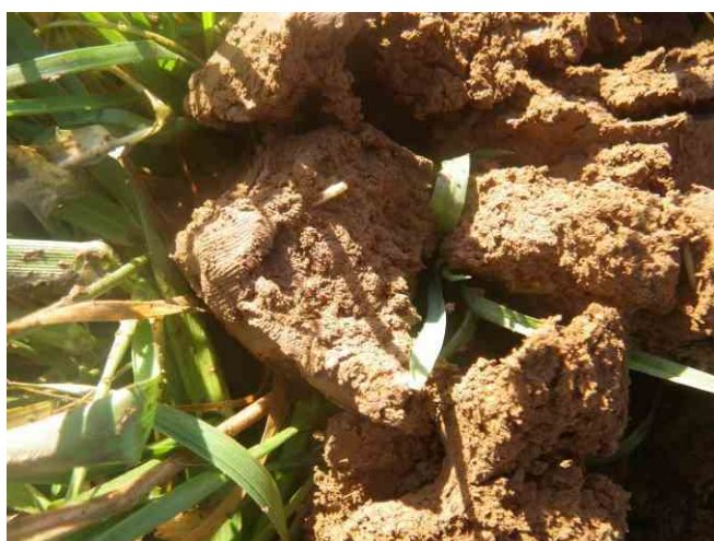
Photo 3 et 4 : Relevé à la tarière montrant l'absence de traces rédoxiques sur le profil pédologique
